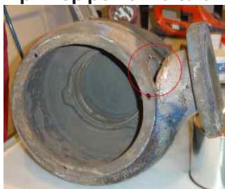
Пример ремонта сквозной дыры Мультиметаллом Чугун
