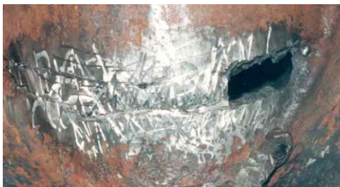
Пример ремонта сквозной дыры Мультиметаллом Чугун
